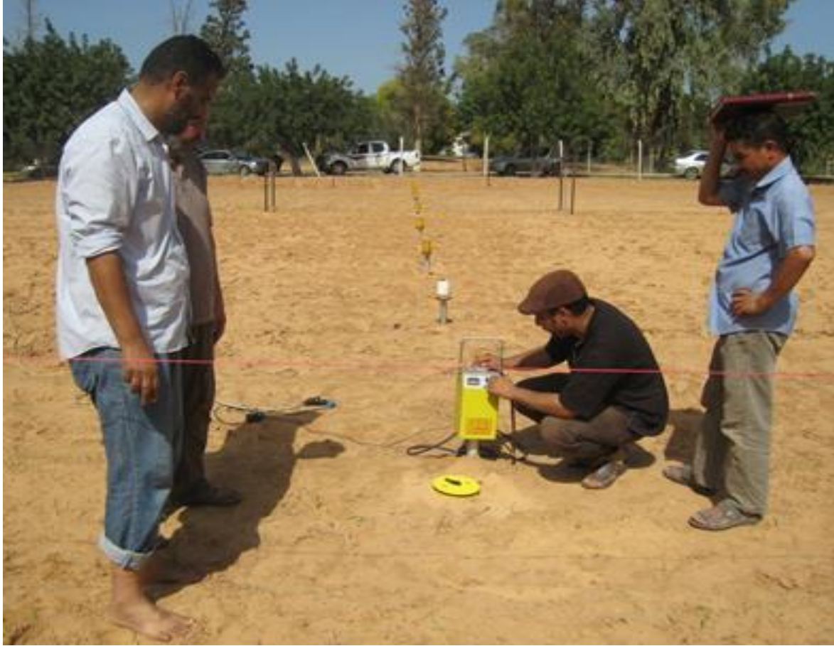
شكل (5.3) : القياس الحقلّي لماء التربة بجهاز المسبار النيوتروني
